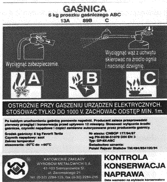
rysunek 3: przykładowa etykieta z gaśnicy proszkowej
