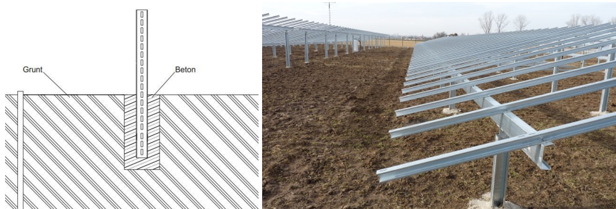
Rys. 17 Konstrukcja zakotwiona w betonie
